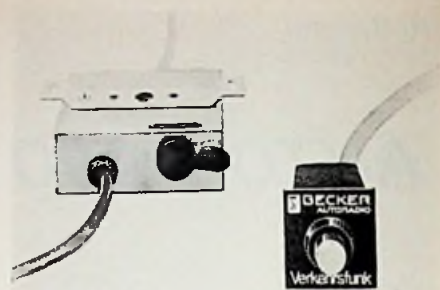
Afb. 6. De Verkeersfunkadapter VA2 van Becker geeft een optische indicatie indien een verkeerszender wordt ontvangen. Bovendien is het mogelijk alleen die zenders hoorbaar te maken, die regelmatig verkeersberichten uitzenden.
